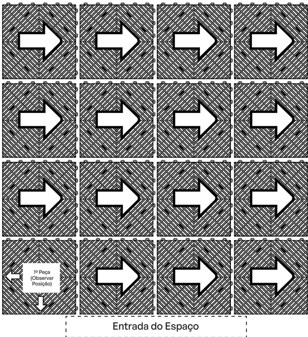
Inicie a montagem do piso pela peça piloto seguindo o fluxo indicado pelas setas. Observe atentamente a posição dos encaixes, após a conclusão da montagem da primeira fileira. Inicie a montagem da fileira subsequente na mesma ordem da fileira anterior, até concluir a montagem do piso.
