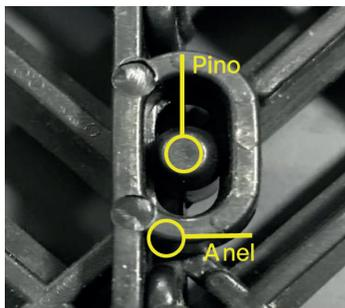
**ATENÇÃO:** No momento de montagem do piso, execute o procedimento cuidadosamente. Os encaixes jamais devem ser forçados. Encaixá-los de maneira imprecisa ou desalinhada pode acarretar na quebra das peças do piso.
